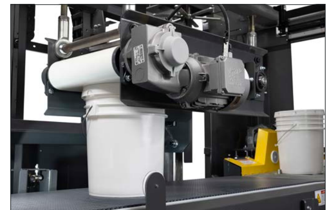
PAIL LID SEALING: AUTOMATIC PRESS
